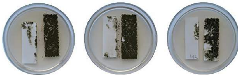
Рис. 7 - Действие AgБион-2: слева в чашках Петри образцы форзацной бумаги, обработанные раствором AgБион-2, справа – образцы бумаги, обработанные водой
